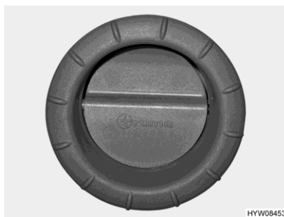
Fig. 51 Bocchetta di uscita dell'aria (riscaldamento ad aria calda)
