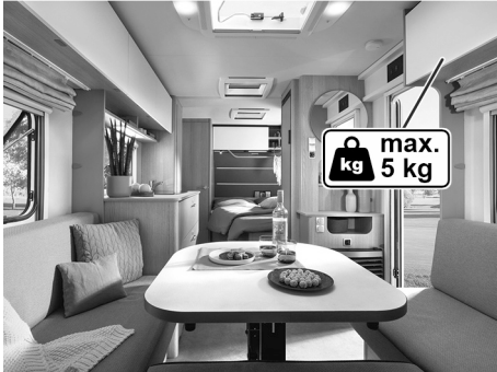
Afb. 61: Hangkasten in het woongedeelte
