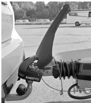
Afb. 13: Trekkogelkoppeling geopend, stabilisatie gedeactiveerd
