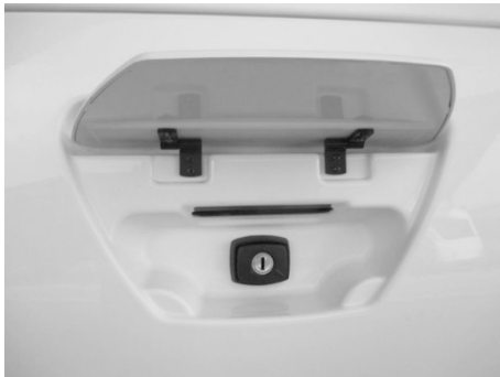
Fig. 75 : Serrure du caisson pour les bouteilles de gaz
