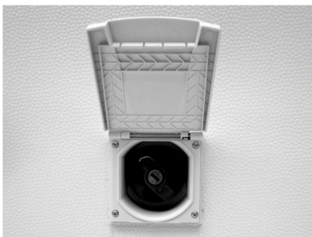
Fig. 95: Manchon de remplissage d'eau fraîche
