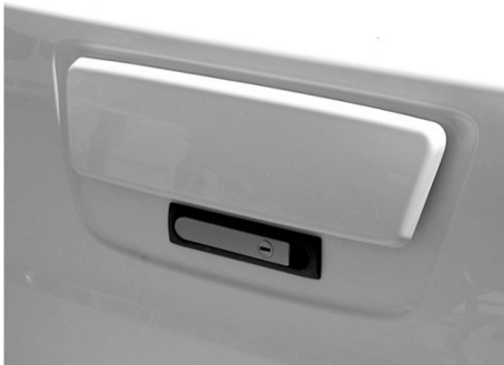
Fig. 21 : Caisson pour les bouteilles de gaz, fermé
