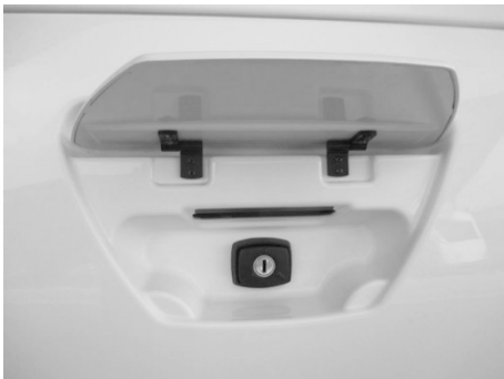
Fig. 22 : Serrure du caisson pour les bouteilles de gaz (exemple)
