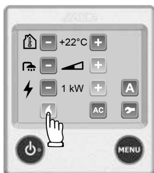
Fig. 169 : Chauffage au gaz
