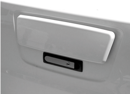
Fig. 73 : Caisson pour les bouteilles de gaz, verrouillé
