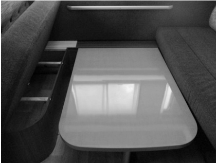
Fig. 189 : Table accrochée dans le rail inférieur.
