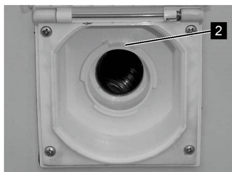
Fig. 108 : manchon de remplissage d'eau fraîche, ouvert
