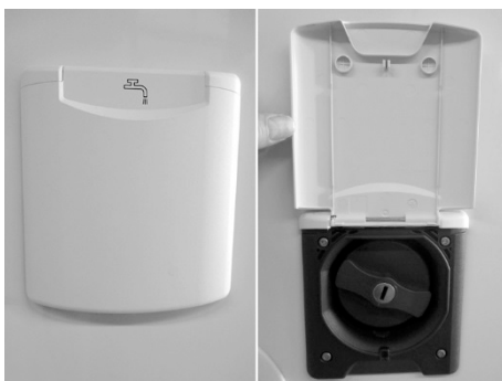
Fig. 23 : Manchon de remplissage d'eau fraîche
