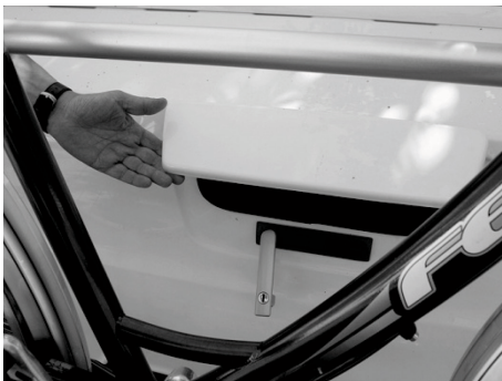
Fig. 74 : Trappe de service ouverte
